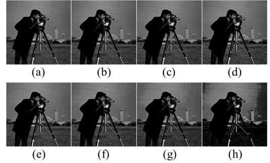
Fig. 4 Image multiplication using R4ABM1 with different  $p$ : (a)  $p=0$ , (b)  $p=2$ , (c)  $p=4$ , (d)  $p=6$ , (e)  $p=8$ , (f)  $p=10$ , (g)  $p=12$ , and (h)  $p=14$ .
